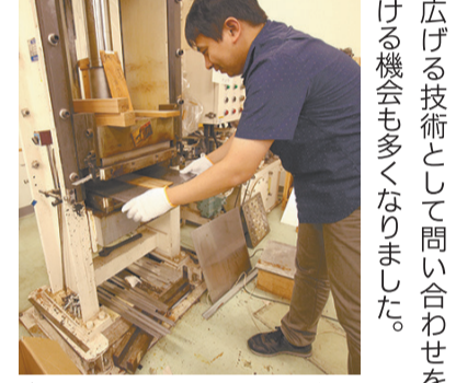
プレス機で木材を圧縮する様子。柔らかい秋田スギも圧力をかけながら熱すると厚さは約1/4になり強度が増す。
